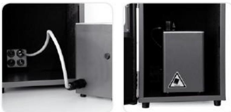
5. 將樣本旋轉組件與超音波水槽連接, 連接後請將黑色旋鈕旋緊
