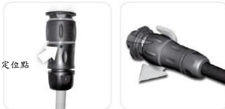
插入超音波主機時，請確認圖上的定位點朝上，插入主機後將內圈卡榫順時針轉緊
