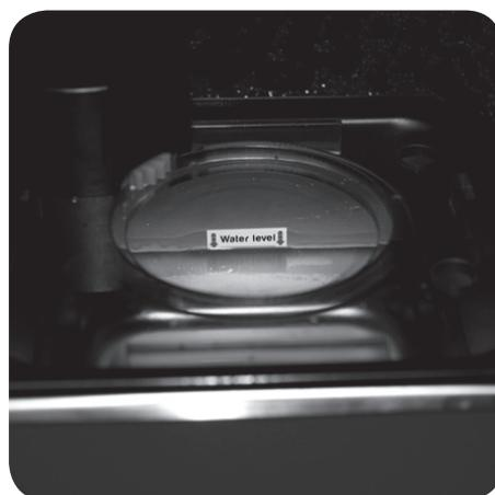
3. 儀器每運行 10 分鐘, 請停機重新檢測水溫與碎冰狀況, 若水溫升高或碎冰溶化, 請立即更換冰水以及添加碎冰, 使樣品保持低溫狀態(或可將儀器置於冷房中進行實驗, 或外接冷卻循環水裝置). 同時將樣本取出混勻後 spin down 後再重新置入樣本架中繼續運行
