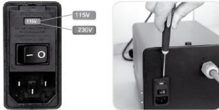
先到電源供應連接器背後，確認連接器上的電壓與當地的電壓相符，若不符合當地電壓，請用扁平頭起子將外罩打開
